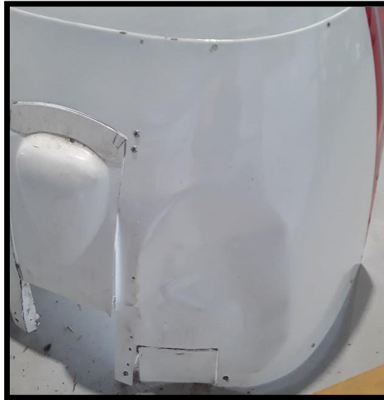
Imagen 8. Daños en el carenado debajo del motor, donde puede verse el hundimiento producido al tomar contacto con el suelo.
