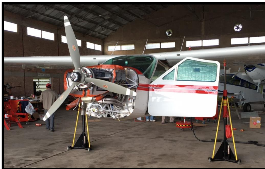
Imagen 2. Foto de la hélice Hartzell instalada en la aeronave.
