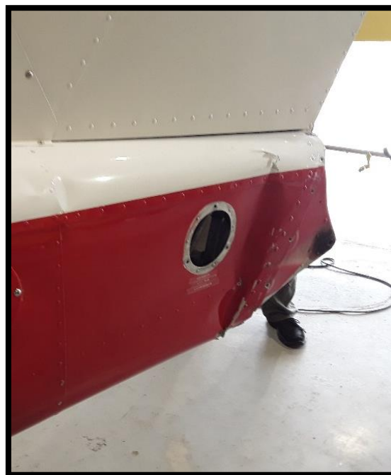
Imagen 9. Cono de cola dañado.
