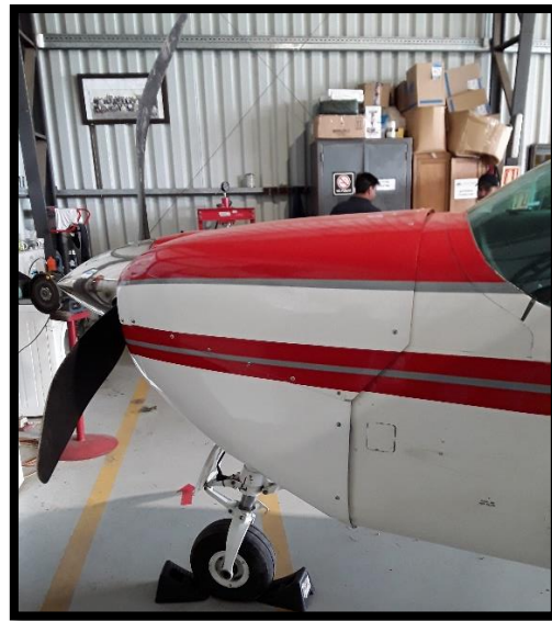
Imagen 7. Palas de helice dobladas.
