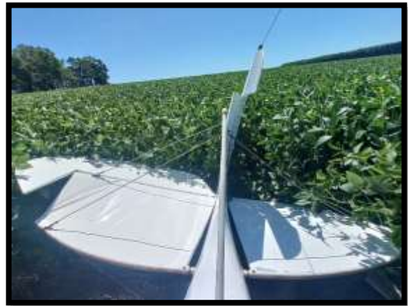
Imagen 5. Estabilizadores y empenaje dañados.
