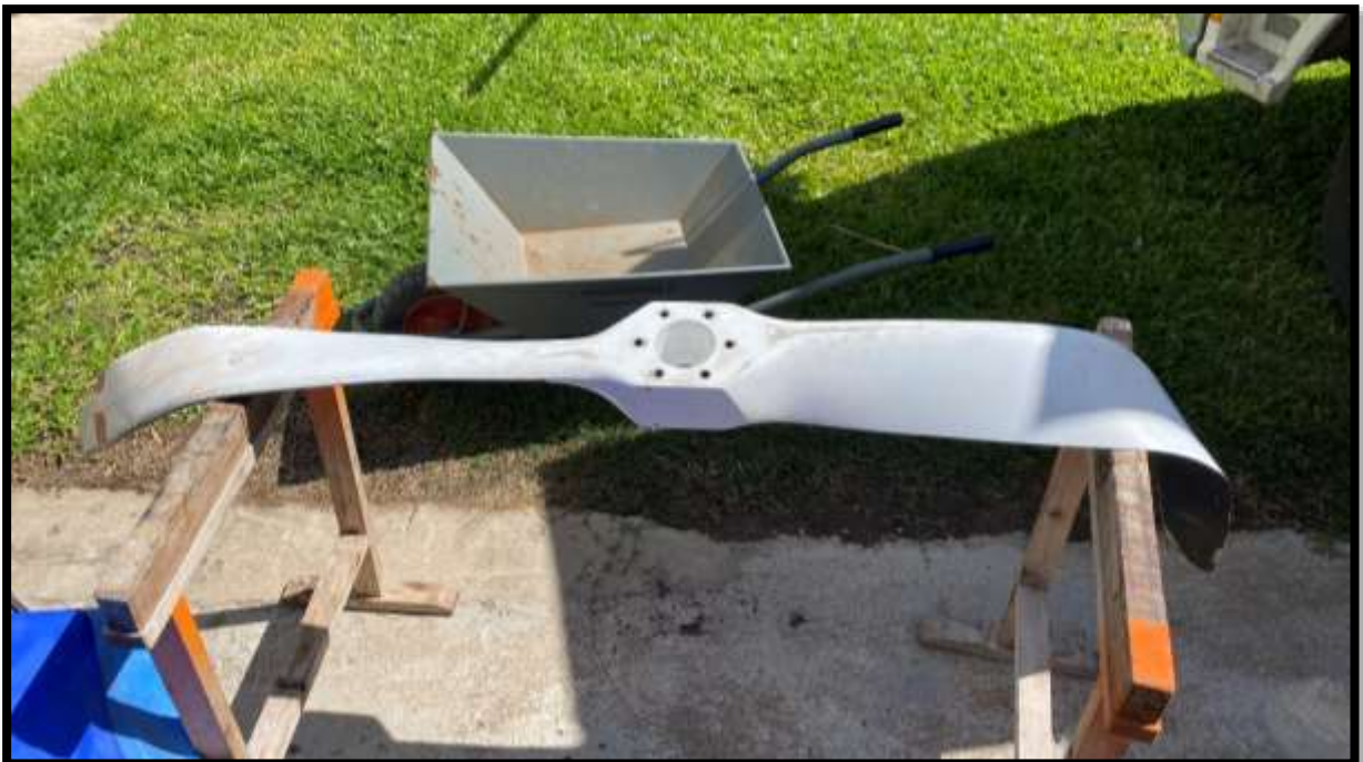
Imagen 6. Hélice dañada. (Foto enviada por el propietario de la aeronave).
