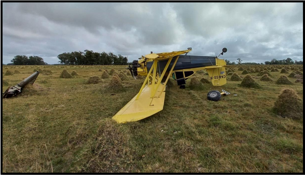
Imagen 7. Tren de aterrizaje principal derecho desprendido.
