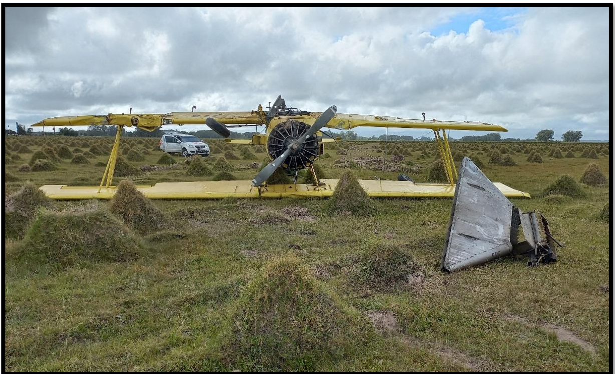
Imagen 6. Equipo de aplicación de solido desprendido próximo a la aeronave.
