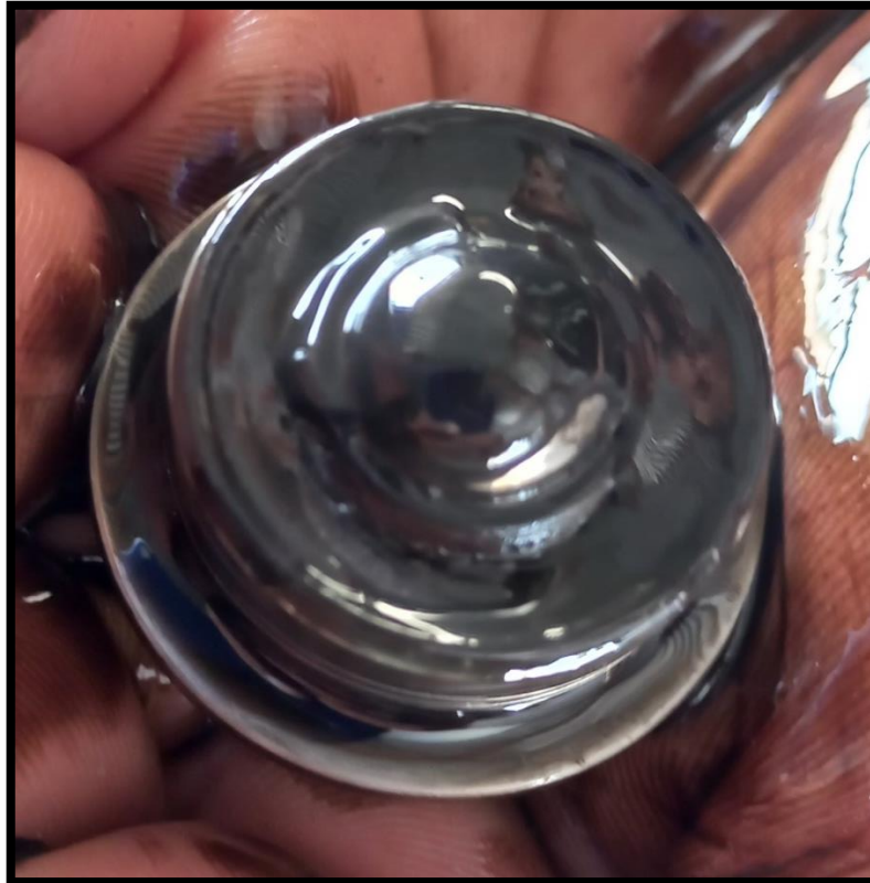
Imagen 11. Tapón de aceite sin partículas ferrosas adheridas
