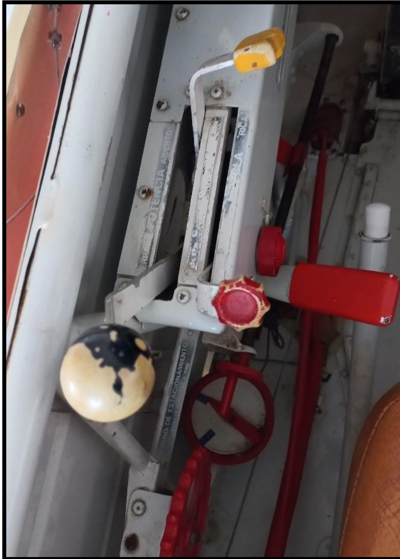
Imagen 12. Disposición de comandos de Embraer Ipanema: Potencia Izquierda (Negro desgastado), Paso de hélice al medio (amarillo), mezcla a la derecha arriba (estrella roja).
