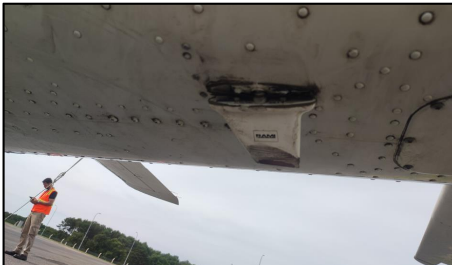
Imagen 4. Antena dañada en la parte inferior trasera del fuselaje.
