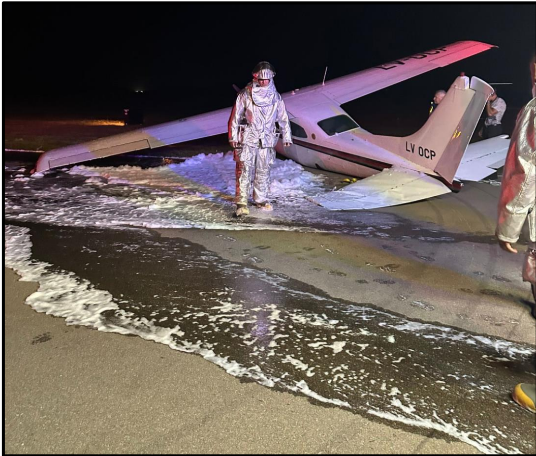
Imagen 9. Espuma aplicada al constatarse la pérdida de combustible
