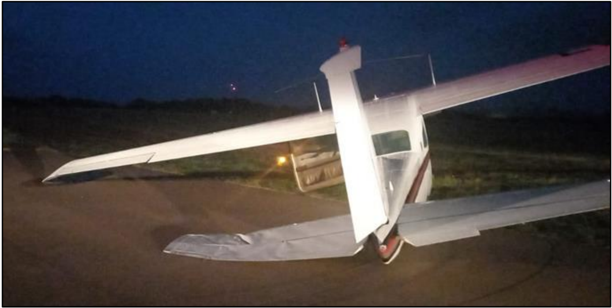
Imagen 3. Daño en el estabilizador horizontal izquierdo.
