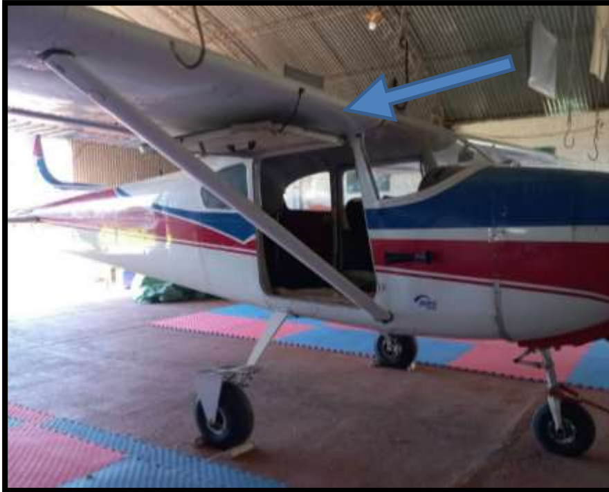
Imagen 9. Puede observarse la plataforma sobre la rueda derecha y la puerta elevada contra el ala.
