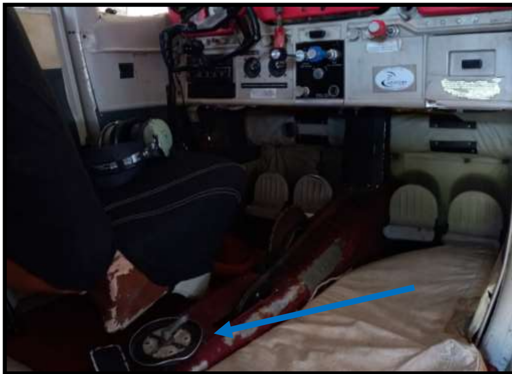
Imagen 8. Válvula selectora de tanques de combustible en uso.
