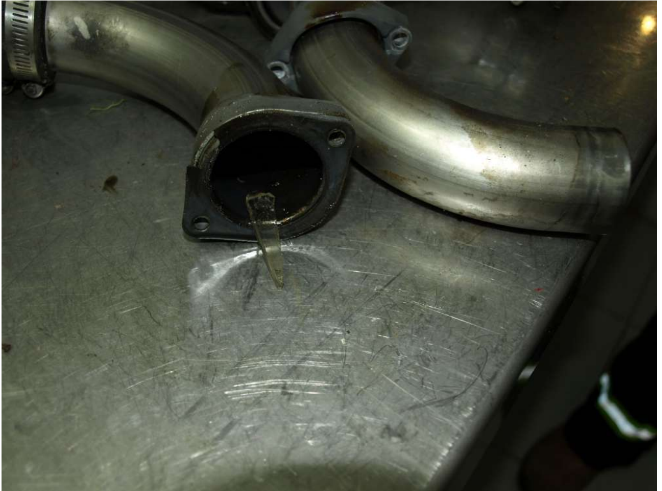
Foto 6. Fragmentos de vidrios de la luz de aterrizaje en los tubos de admisión de aire a los cilindros.
