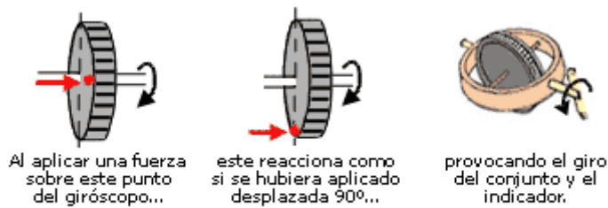
Fig.2.8.4 - Funcionamiento del indicador de viraje.
