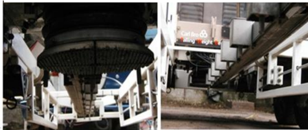
Ilustración 7 IMAGENES DE LOS GEOFONOS DEL DEFLECTOMETRO SHWD
