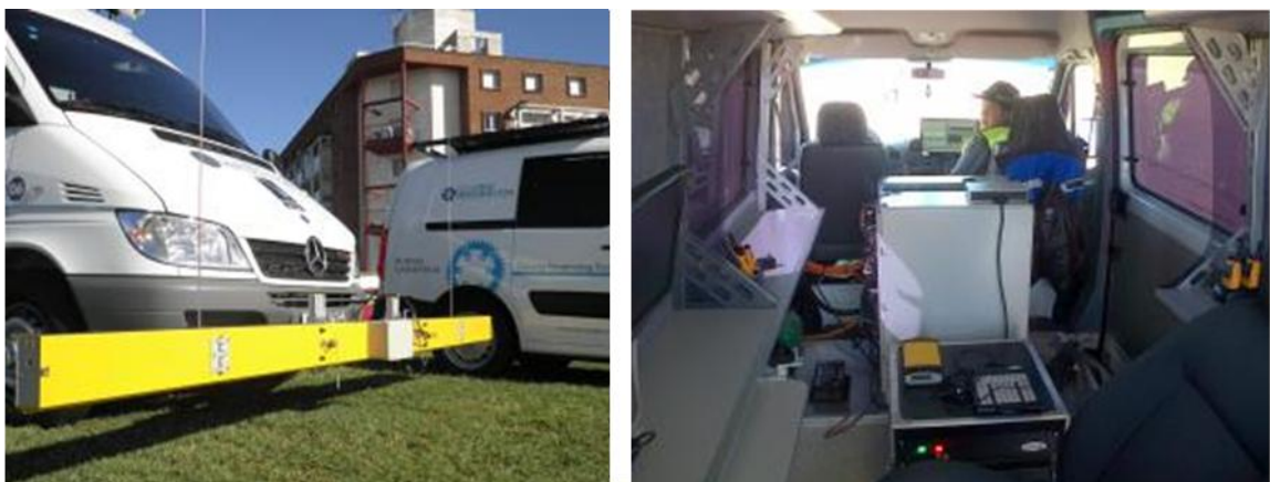
Monitores de abordo en el vehículo multifunción de INEXTEC - ECUATEST INGENIERIA DEL SUR con los sistemas ROMDAS Y HAUWKEYE
