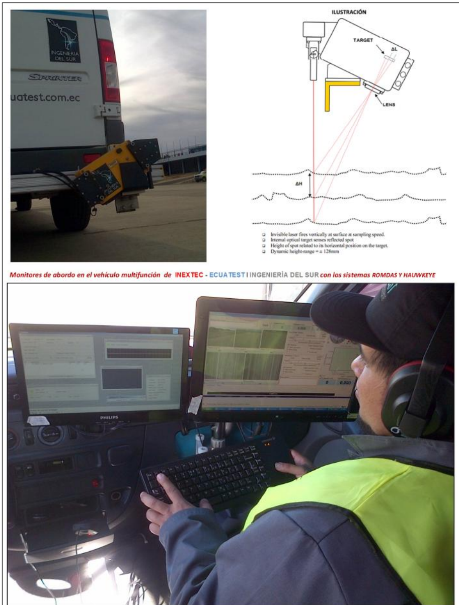
Ilustración 9 VEHICULO MULTIFUNCION - DISPOSITIVOS LASER PARA DETERMINACIÓN DEL IRI
