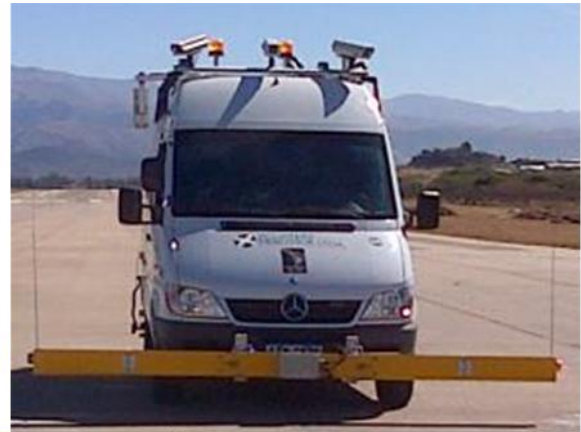
Monitores de abordo en el vehículo multifunción de INEXTEC - ECUATEST INGENIERIA DEL SUR con los sistemas ROMDAS Y HAUWKEYE
