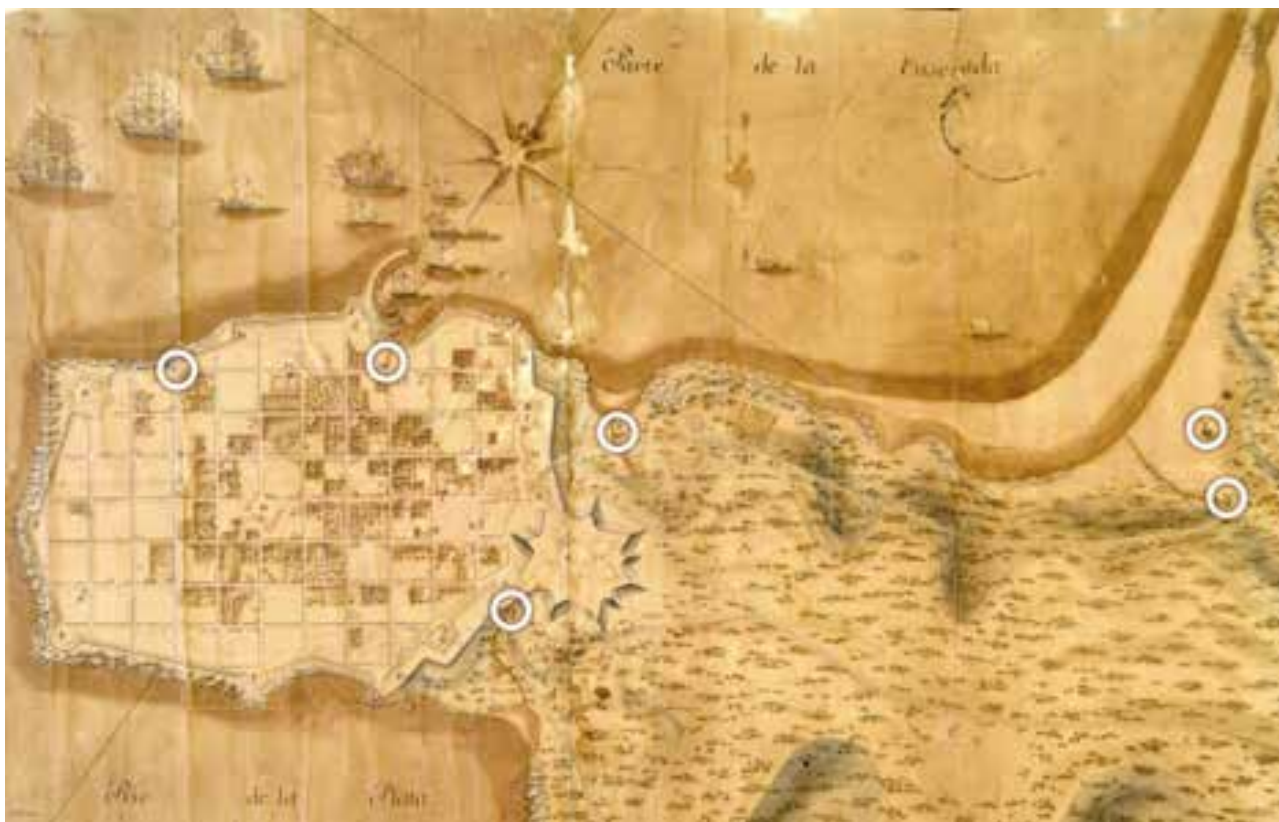
Fig. 1. Plano de la Plaza de Sn. Phelipe de Montevideo en el Río de la Plata . Ing. Diego Cardoso, 1766. Acuarela y tinta/s/papel. Tamaño: 61 × 94 cm. Se señala: P «Dos fuentes nuevas del Rey hechas el año pasado»; Q «Dos manantiales dentro de la Plaza»; X «Fuente de las Canarias»; Y «Aguada de los Navíos». En Colección Museo Histórico Cabildo de Montevideo. N.º Inventario: L1/40/4. Índice fotográfico: IF 1916
