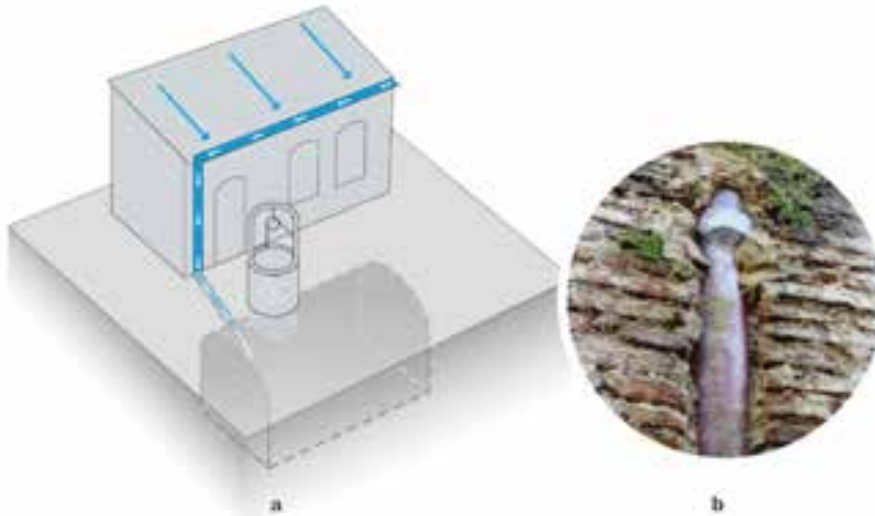
Fig. 30a. Croquis de un aljibe. 30b Canalización de cerámica vidriada empotrada en la pared del patio, calle Sarandí, Ciudad Vieja. Caso n.º 13
