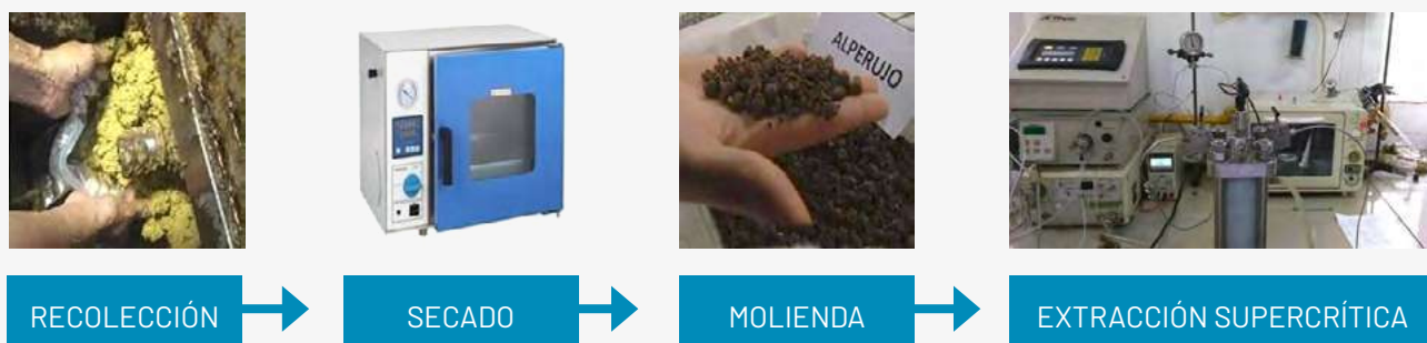
Diagrama del proceso de obtención de extractos con actividad antioxidante mediante tecnología supercrítica a partir del alperujo
