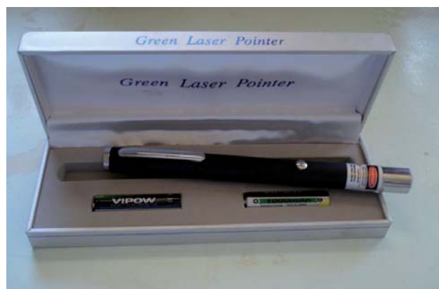
Figura 40. Láser manual clase IIIB tipo diode utilizado en el ensayo.
