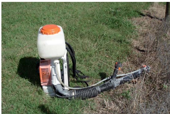
Figura 47. Máquina de niebla (fogger) marca Hatzuta, con la cual se realizó la aplicación en girasol.
