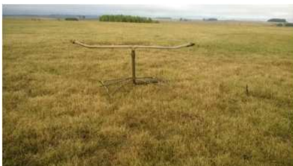
Figura 5. Riego de efluentes con un regador estático de alto caudal.
