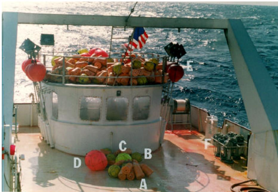
Figura 13. Boyas utilizadas. A, tipo “bullet”; B, tipo A2; C, tipo A4 de 52 cm; D, tipo A4 de 60 cm; E, boya con reflector de radar; F, radioboyas.
