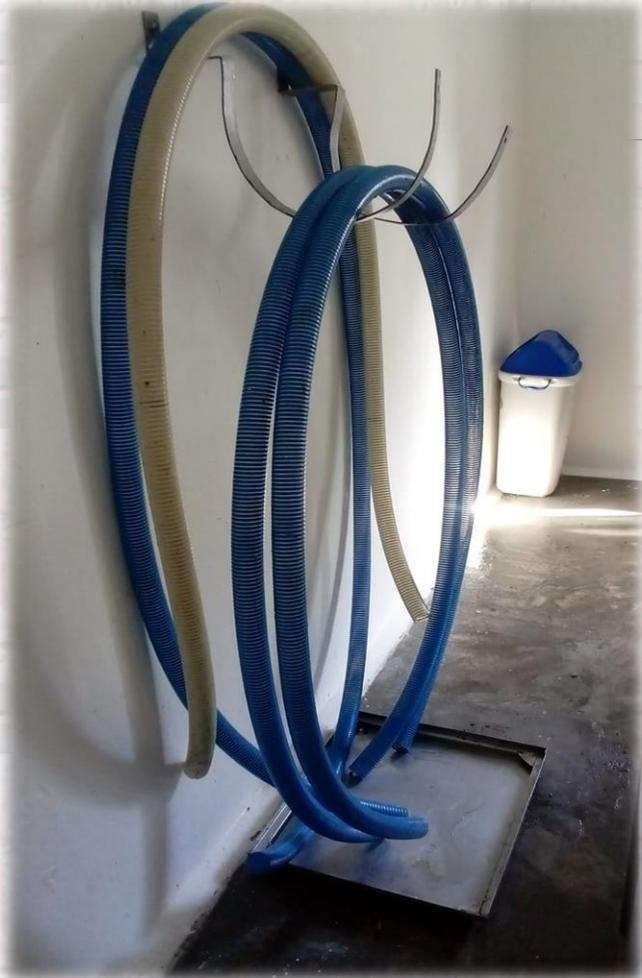
5. Mangueras calidad alimentaria, traslúcidas, con sistema de acople o juntas fáciles de desmontar, lo que facilita la manipulación y los procedimientos de limpieza
