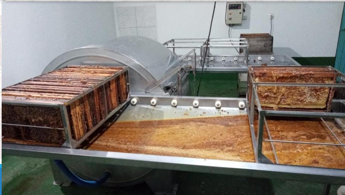
Centrífuga con diseño desactualizado, falta de mantenimiento y uso inadecuado: falta de tapa, engranaje en parte superior que drena la grasa de las poleas hacia el interior del extractor, además de las abejas muertas y aplastadas, donde termina mezclándose con al miel extraída.
