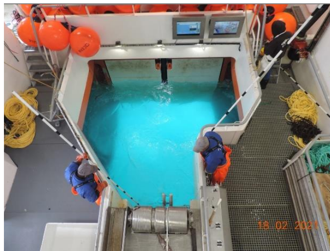
Figura 5. Área de trabajo de ingreso/salida del del sistema denominada “moonpool” del B/P Ocean Azul.
