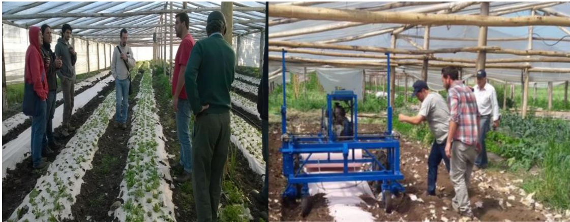
Evaluando el mulch de papel en invernáculo (izq.) y colocadora de papel autopropulsada (der.)
