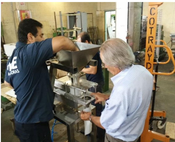
Prueba y ajuste de la línea de envasado de semillas entre productores y técnicos de la empresa constructora
