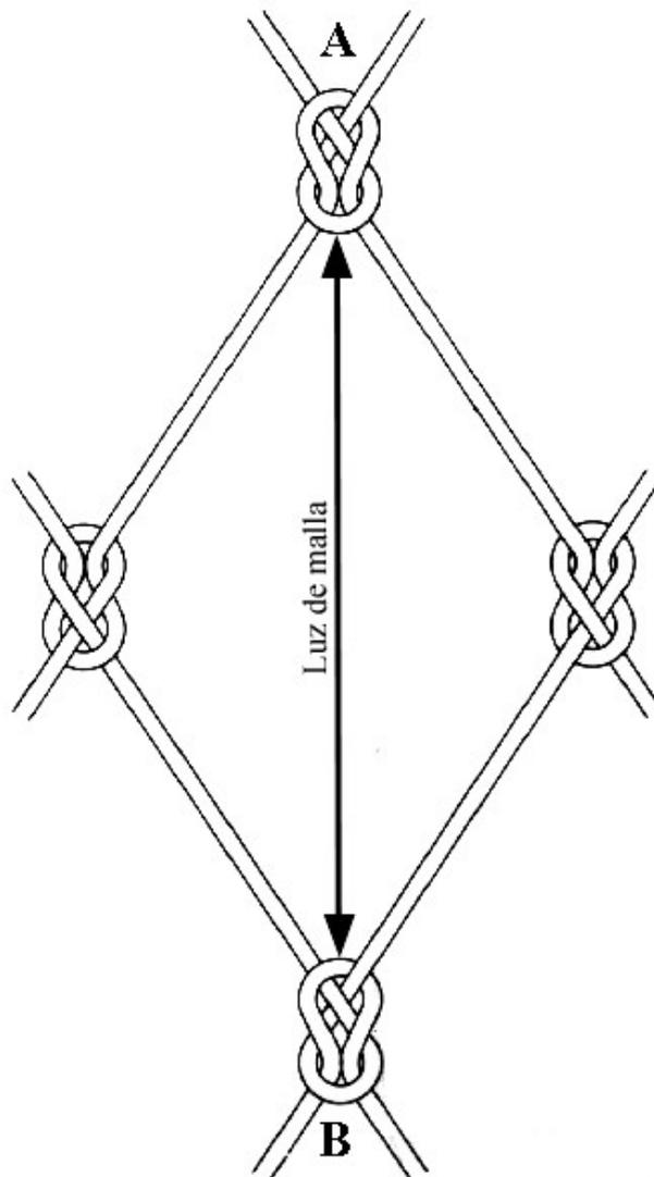
Figura 2. – Esquema para la medición de luz de malla entre nudos opuestos, para las redes de arrastre de fondo.
