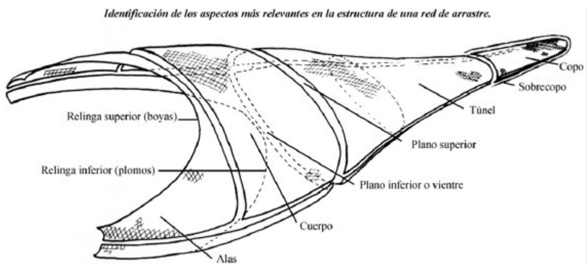
Figura 1. – Esquema de una red de arrastre de fondo.
