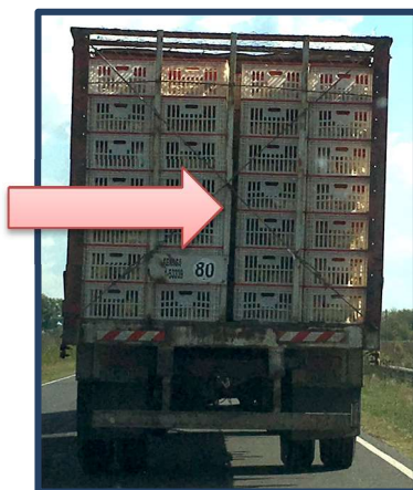
Figura Nº 6: Pasillo central que permite la circulación de aire entre las jaulas (flecha roja).
