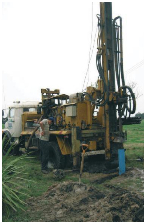
Fig. 17. Máquina perforadora. Método de rotopercusión
