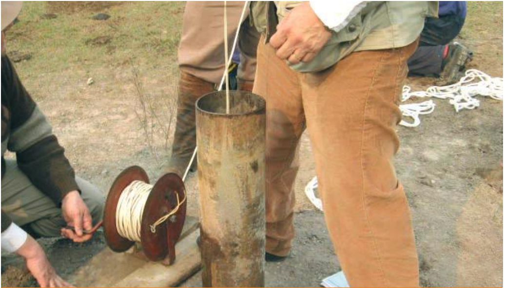
Fig. 30. Medición de profundidad de pozo y de niveles de agua
