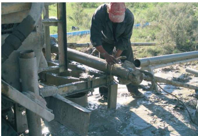
Fig. 17. Máquina perforadora. Método de rotopercusión
