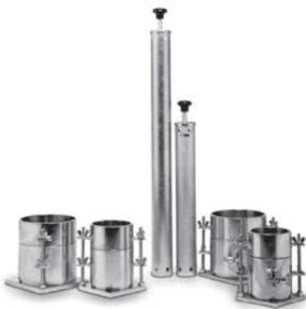
Figura 6 - Equipo de laboratorio para ensayo Proctor de compactación manual
