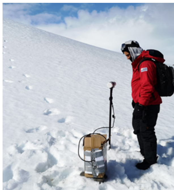
Figura 5: Izquierda: Magnetómetro Móvil. Derecha: Estación Base sobre caja con material aislante.
