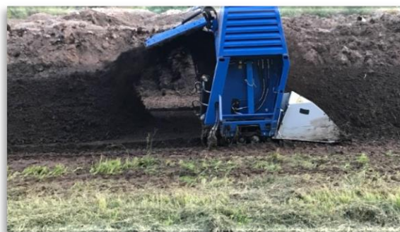
Imagen 5: Volteadora autopropulsada en funcionamiento. Se observa como desplaza el material al voltearlo.
