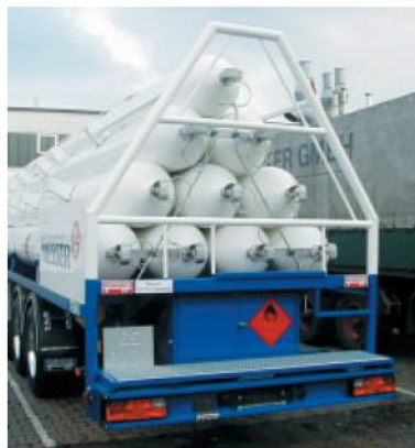
Ilustración 31 - Tube Trailer de 9 cilindros de MCS International GmbH (Fuente: TECNORed)
