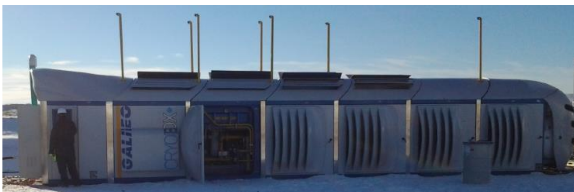
Ilustración 35 - Sistema de Licuefacción de Metano de Galileo Technologies S.A. (Fuente: TECNORed)
