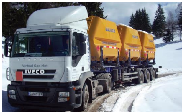
Ilustración 34 - Sistema de Transporte SIMT VST-3 de Galileo Technologies S.A. (Fuente: TECNORed)
