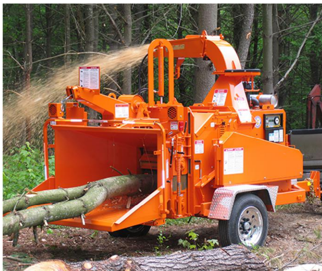
Figura nº. 2. Desfibradora o chipeadora de fracción vegetal
