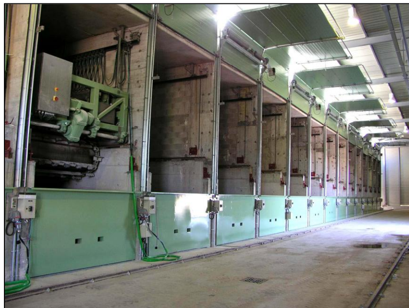
Figura nº. 11. Túneles dinámicos zona de entrada de la volteadora
