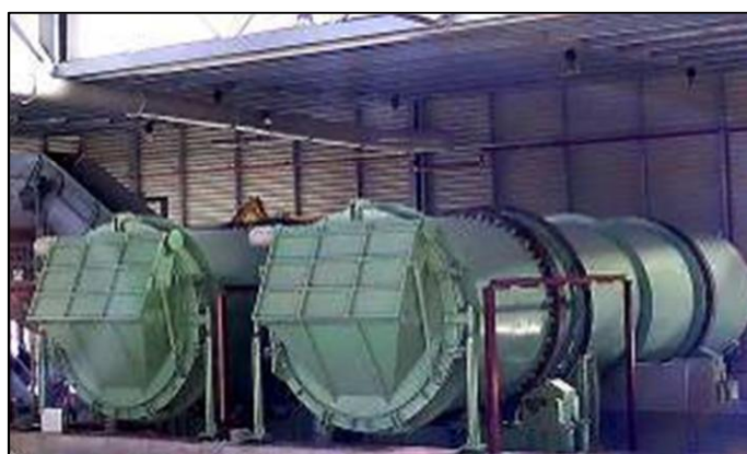
Figura nº. 12. Tambores de compostaje por cargas
