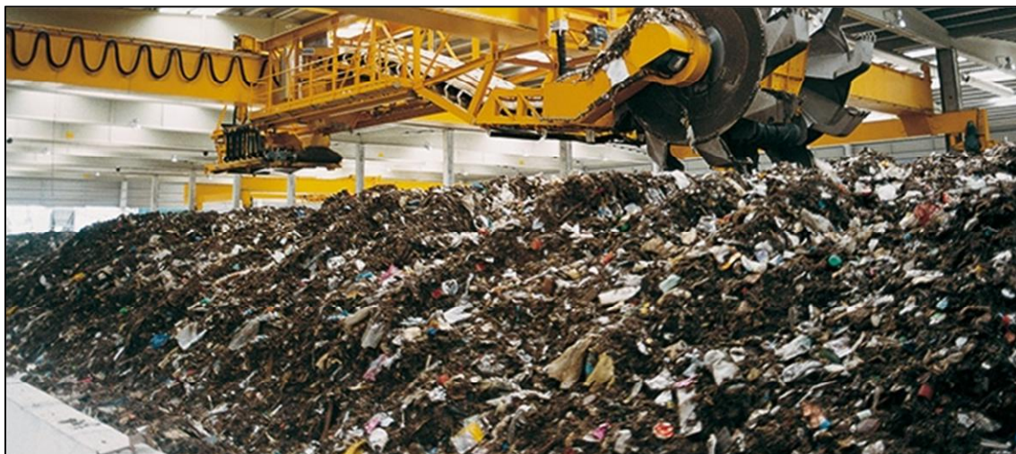
Figura nº. 14. Volteadora sobre carro, detalle y esquema
