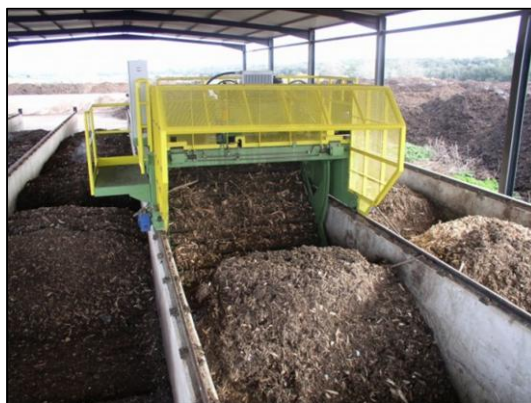
Figura nº. 19. Trinchera dinámica con volteadora en nave abierta
