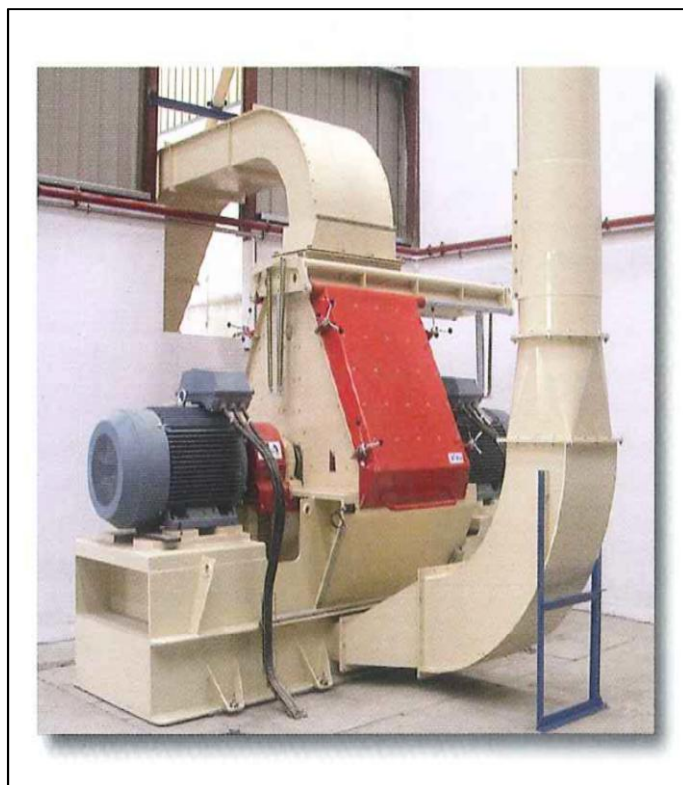
Figura nº. 21. Molino de martillos
