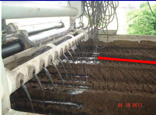
Espalhador de Dejetos no Leito Compostagem
