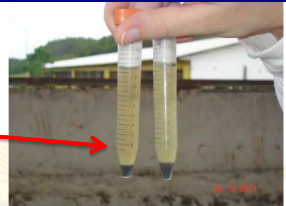
Concentração de Sólidos na Saída do Espalhador
