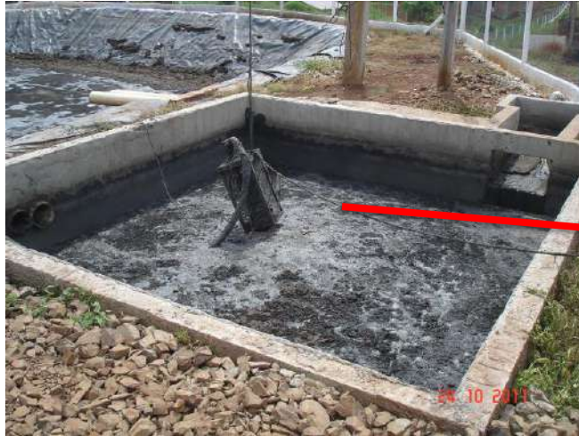
Espalhador de Dejetos no Leito Compostagem
