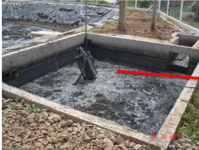
Espalhador de Dejetos no Leito Compostagem
