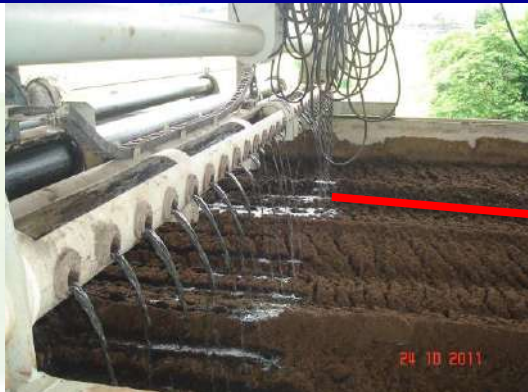
Espalhador de Dejetos no Leito Compostagem
