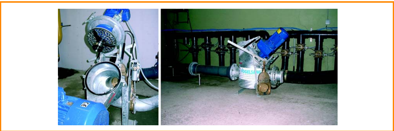
Figura 3.8: Triturado de sustrato en tuberías (con dispositivo de triturado de placa perforada) [Hugo Vogelsang Maschinenbau GmbH]
