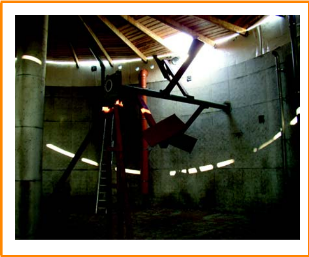
Figura 3.34: Agitador de paletas [PlanET GmbH]
