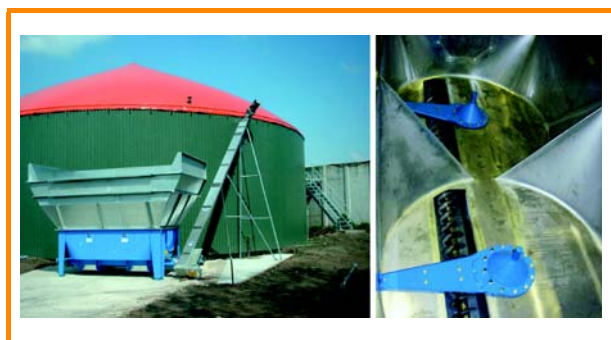
Figura 3.6: Receptor con aflojador [Konrad Pumpe GmbH]
