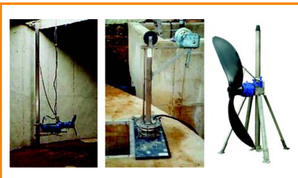
Figura 3.31: Propulsor SMA (izquierda), sistema de tuboguí (centro), rotor de cuchillas grandes SMA (derecha) [Agrartechnik Lothar Becker (izquierda, centro), KSB AG]
