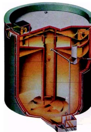
Figura 3.27: Digestor de dos cámaras [ENTEC Environment Technology Umwelttechnik GmbH]
