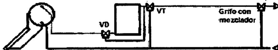
7. Los sistemas de calentamiento auxiliar que utilizan válvulas mezcladoras, para proteger al equipo o al usuario de temperaturas elevadas, puede reducir significativamente el caudal de consumo que pasa por el equipo solar por lo que penaliza el rendimiento y las prestaciones energéticas de la instalación solar.
