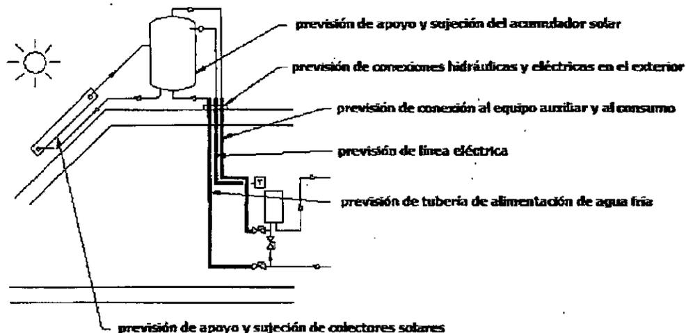
1. En la preinstalación de un pequeño sistema solar térmico, sea compacto o integrado, se deben tener en cuenta todos los condicionantes necesarios para el montaje del equipamiento que, básicamente, estarán relacionados con los espacios disponibles, las previsiones estructurales para apoyo y sujeción de colectores y acumuladores, con todos los complementos que sean necesarios, así como las condiciones de traslado y montaje.
