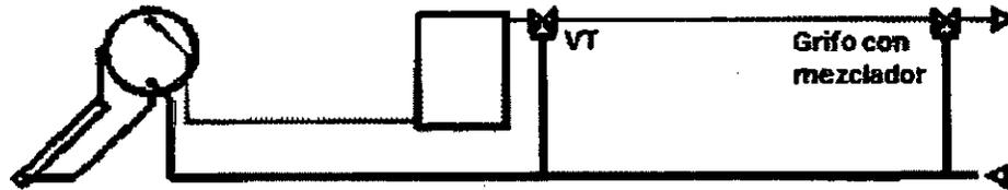
5. Cuando el sistema de apoyo, o sus accesorios del circuito de consumo, no soporten la temperatura máxima que pueda suministrar el equipo solar, la instalación deberá disponer de una válvula de tres vías a la salida del equipo solar o un sistema que produzca un efecto similar. Si se garantiza que al punto de consumo del usuario no llegan más de 60°C, se puede eliminar la válvula termostática mezcladora a la salida del equipo de apoyo.
