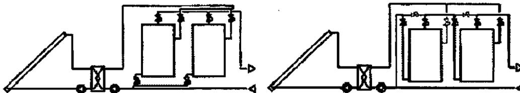
7. Para el conexonado de los acumuladores se pueden utilizar ramales que se utilizan en los dos circuitos o, preferentemente, la conexión directa en el cada acumulador.
