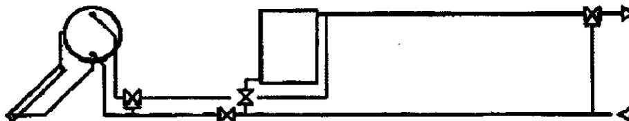
12. Cuando el equipo auxiliar requiere válvula termostática mezcladora se debe montar en la salida a consumo y opcional y adicionalmente se podría montar otra en el SST
