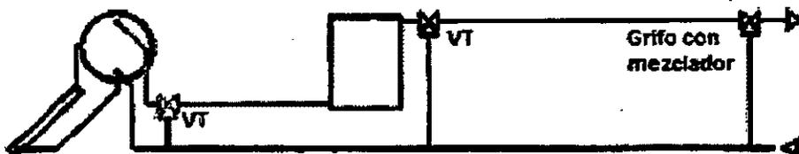
6. También se podrá utilizar la opción de que la válvula de 3 vías sea diversora VD y su función sea hacer la función de bypass el sistema de apoyo para canalizar el fluido directamente a la válvula mezcladora posterior al sistema de apoyo.
