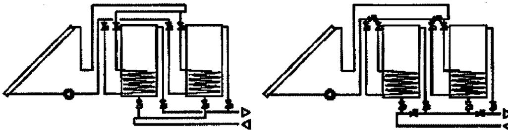
4. En el caso de que deban conectarse en paralelo se asegurará el equilibrado de los circuitos con la medida del caudal o de las temperaturas de salida.
