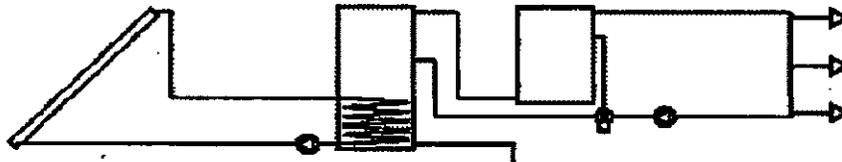
6. En algunas instalaciones, normalmente de tamaño medio con una gran variación del consumo, se puede mejorar la eficiencia de la instalación global si se utiliza, como alternativa a la recirculación indicada anteriormente, una bomba de trasvase entre el acumulador solar y el sistema auxiliar con la estrategia de control de que funcione cuando la temperatura en el acumulador auxiliar sea inferior a la de la parte alta del acumulador solar:
