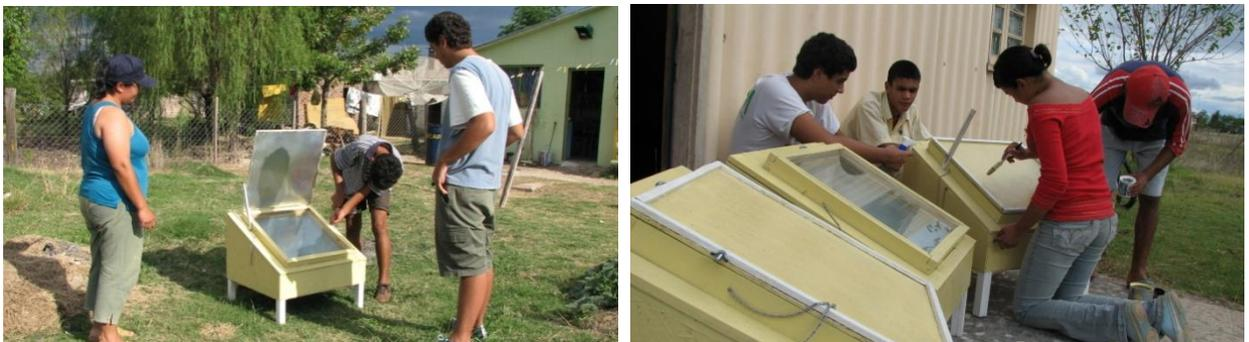
Podemos definir a estos sistemas como trampas de calor que realizan una conversión de la radiación solar en energía calórica.
