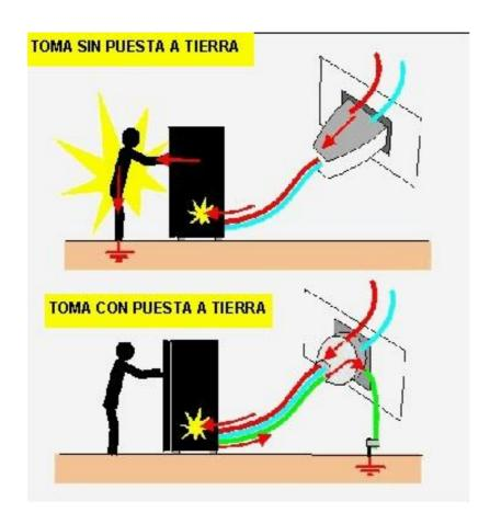
Es una unión de todas las carcasas o chasis metálicos de los artefactos eléctricos, mediante cables de sección suficiente, y un electrodo o grupo de electrodos que pueden ser constituidos por barras, tubos, placas, cables, pletinas u otros perfiles, preferentemente de cobre, enterrados en el suelo (pueden ser las llamadas jabalinas).
