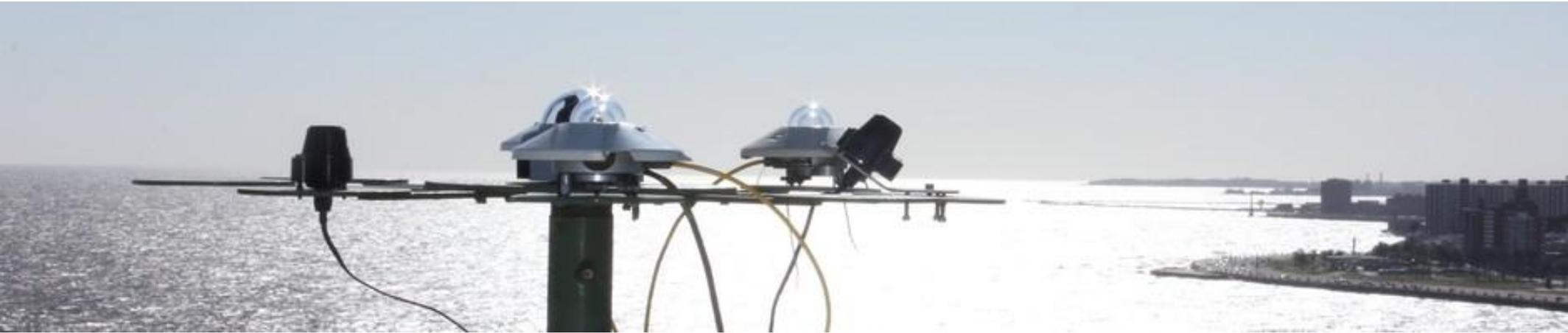
Primeras calibraciones de radiómetros bajo norma ISO 9848 realizadas en la azotea de la Facultad de Ingeniería
