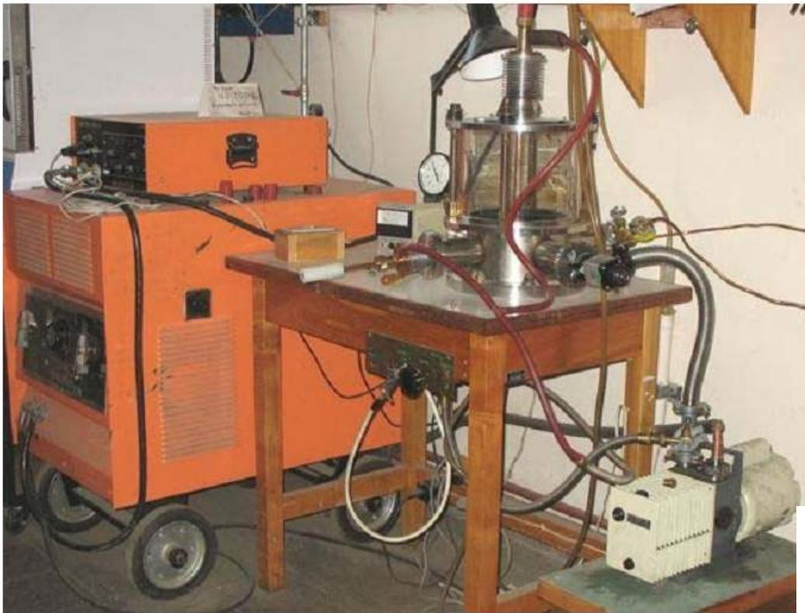
Horno de arco eléctrico para la fabricación de las aleaciones hidrurables
