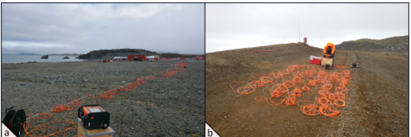
Figura 3. Tomografía eléctrica. (a) Armado de línea para generar modelo 2D sobre cordones litorales de la bahía; (b) Armado de grilla para generar modelo 3D a los márgenes del Lago Uruguay.
