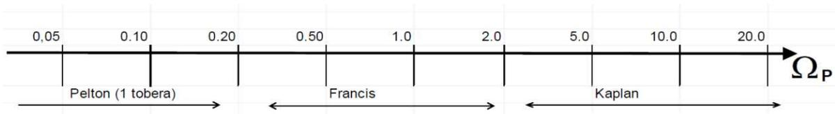
Las turbinas mayores ser3n de tipo axial, dado que, suponiendo  $N = 500 \text{ rpm}$  y rendimiento 0.85, su velocidad espec3fica ser3  $\Omega_p = 2.9$ .
