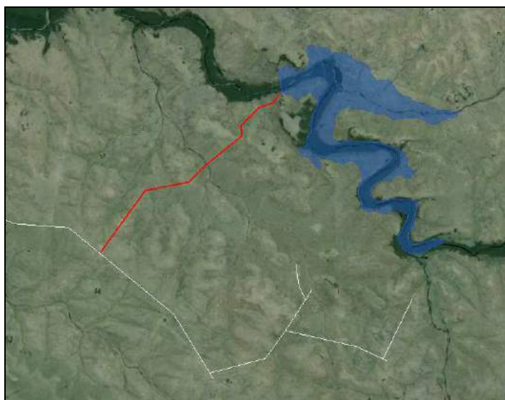
Figura 7-69: Tendido eléctrico hasta línea de 15 kV - Mataojo Gde.
