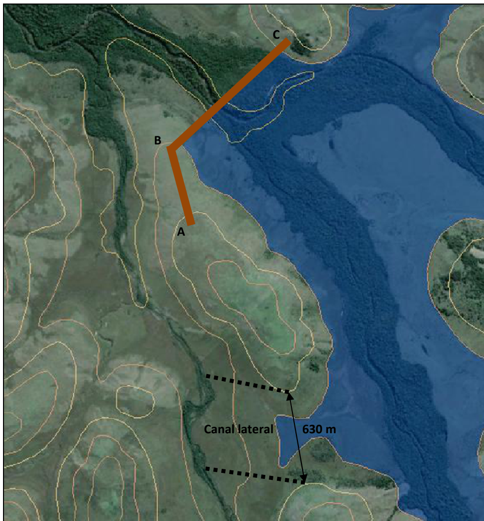
Figura 7-13: Configuración propuesta para el vertedero tipo canal - Tres Cruces
