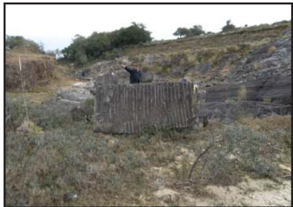
Foto 69: Se observa bloque escuadrado y marcas de barrenos.
