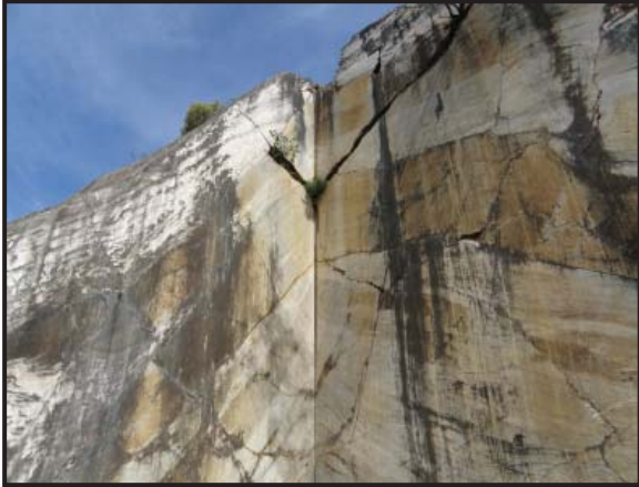
Foto 76: Corte con hilo en dos planos del frente.
