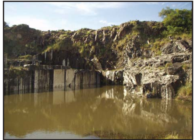
Foto 82: Frente de cantera, se observa corte con hilo.
