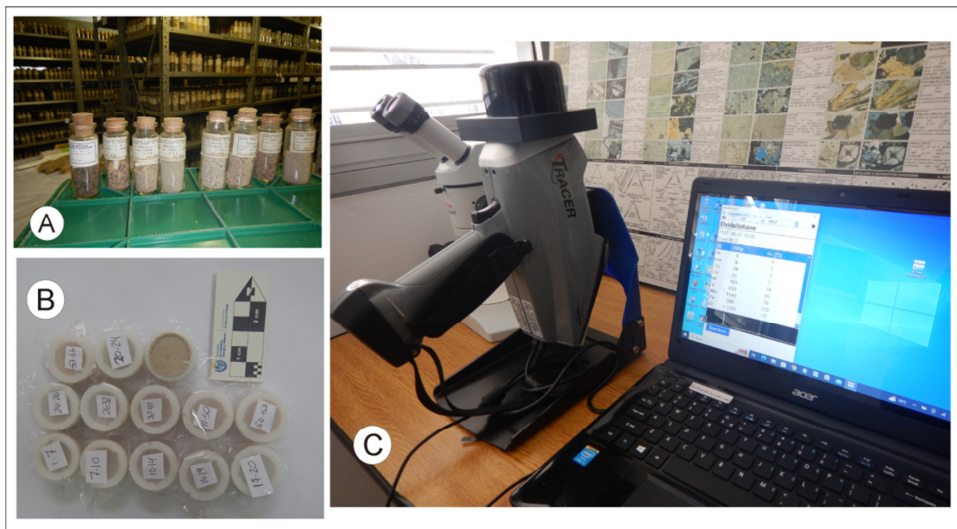
Figura 38: Testigos de perforación para medición de contenido arsénico (A), muestras pulverizadas prontas para la medición (B), Analizador pFRX y programa de configuración (C)
