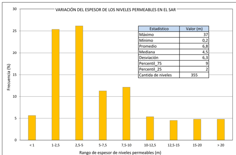
Figura 19: Variación del espesor de los niveles permeables en las perforaciones del SAR
