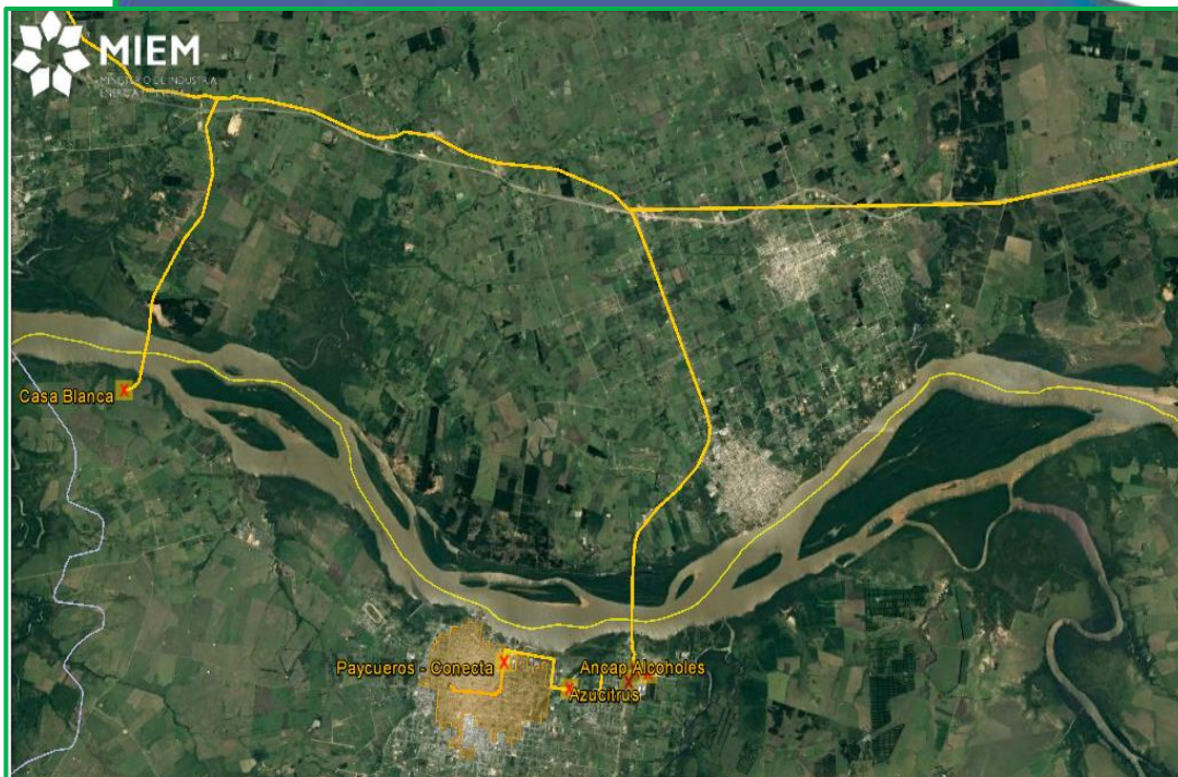
Fig.32: Gasoducto del Litoral
