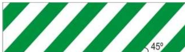
**Figura 20 – Franjas de seguridad para indicar una condición de seguridad.**
