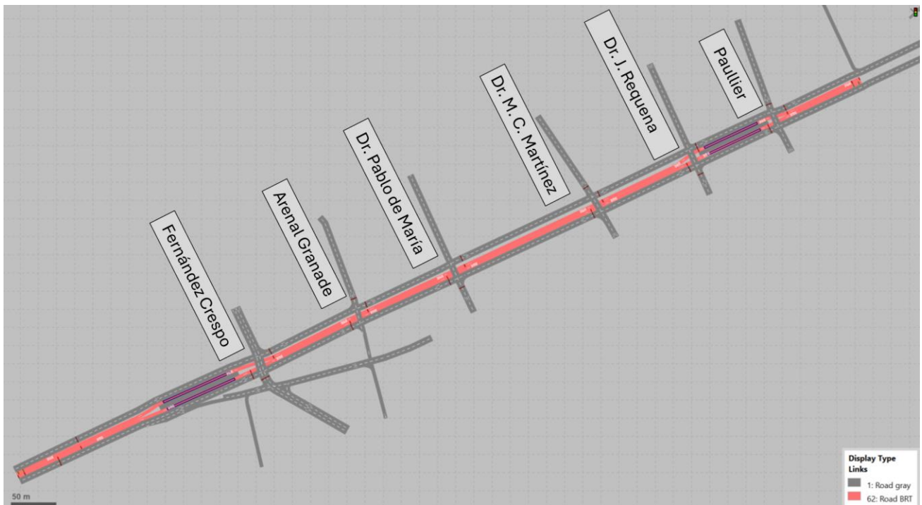
Figura 136. Red de modelo de microsimulación en situación de superficie. Fuente: Elaboración propia con PTV VISSIM
