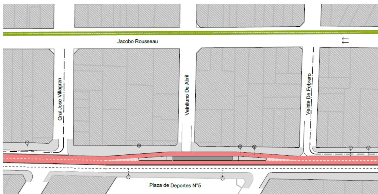
Figura 33. Propuesta Inicial del Corredor BRT – Tipología del tramo Tres Cruces – Belloni con par vial. Fuente: Proyecto de Movilidad Metropolitana – FADU, 2025
