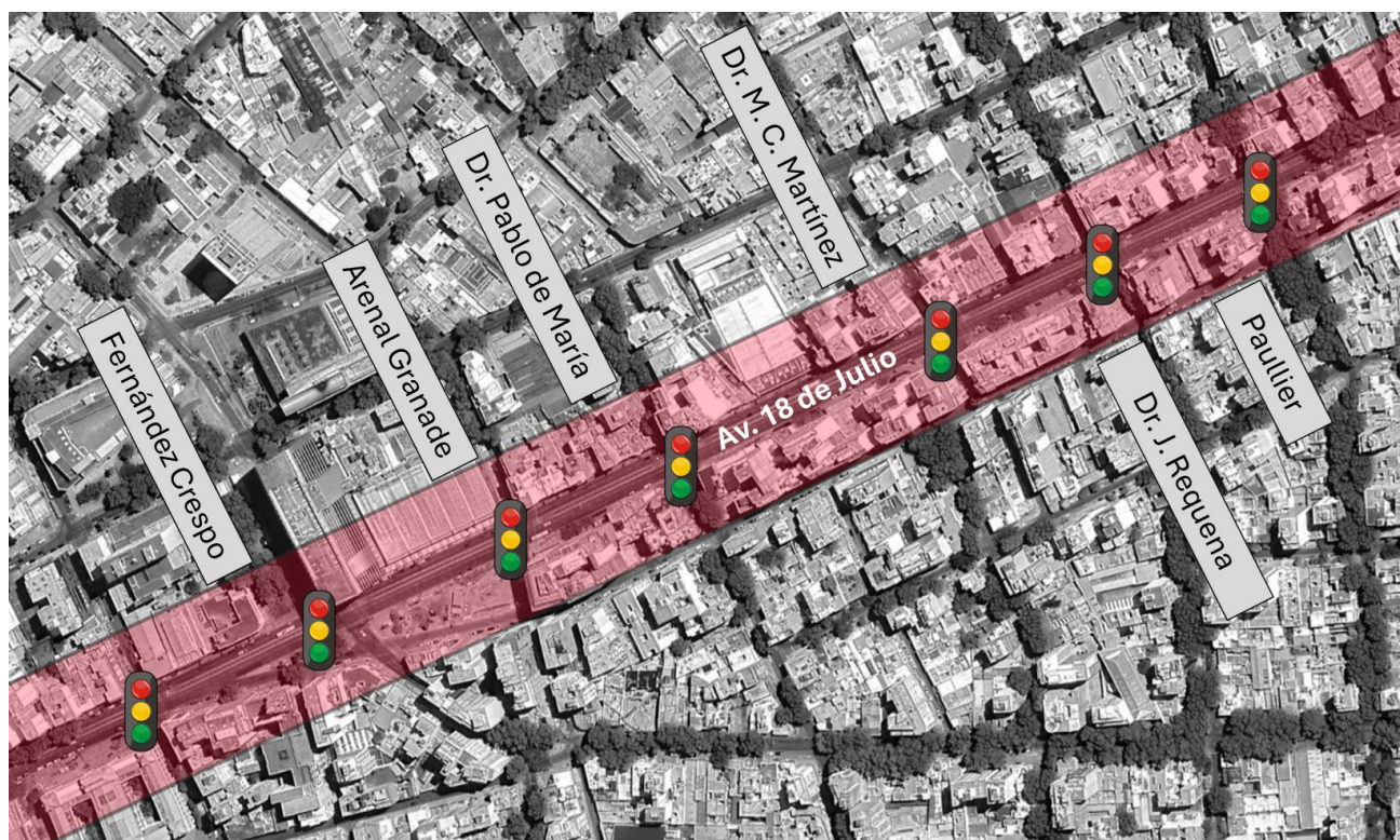
Figura 138. Trazado de microsimulación y ubicación de semáforos. Fuente: Elaboración propia
