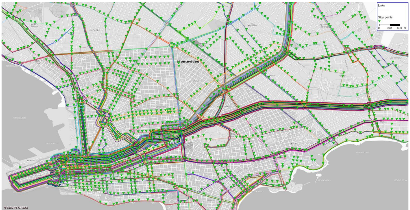
Figura 51. Sistema de paradas generadas para las rutas de transporte público en PTV VISUM. Fuente: Elaboración propia
