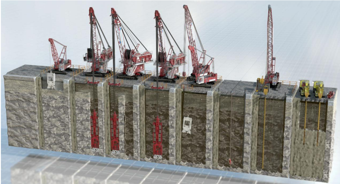
Figura 4-18. Ejecución de pantalla mediante hidrofresa
