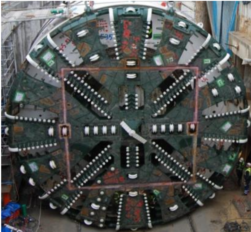
Figura 4-12. Rueda de corte de tuneladora EPB túnel Atocha – Chamartín (Madrid)
