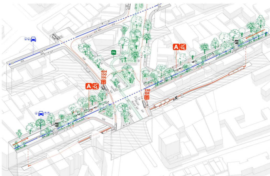
Figura 3-4 Esquema de paso inferior en 8 de Octubre y Luis Alberto de Herrera.
