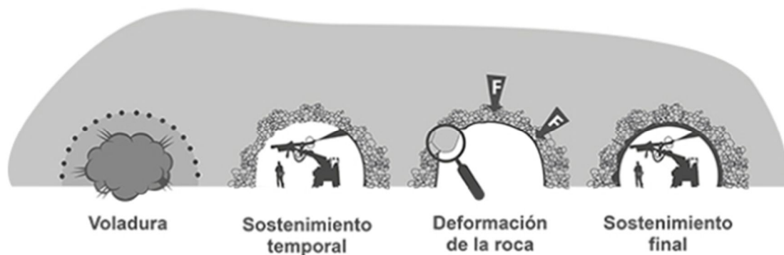
Figura 3: etapas constructivas en el método NATM.
