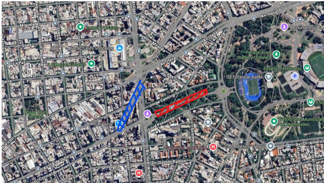
Figura 5: en rojo zona de ataque y rescate de la TBM, en azul sector a ejecutar con método cut and cover o tradicional.
