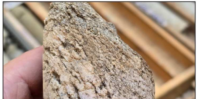
Plano de fractura consecuente asociado a la densificación de los planos interfoliares
