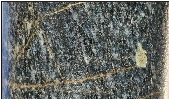
Fracturas obsecuentes soldadas, milimétricas.
