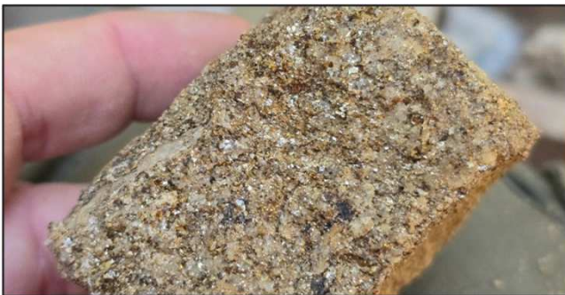
Gneis máfico (rico en biotita) en plano de fractura consecuente. Clase IV de alteración.
