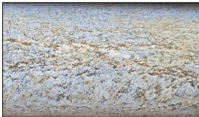
Gneiss granítico félsico a biotita con foliación subparalela al eje de la perforación.
