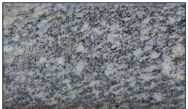
Foliación bien desarrollada en una zona del testigo en Clase I/II de alteración.
