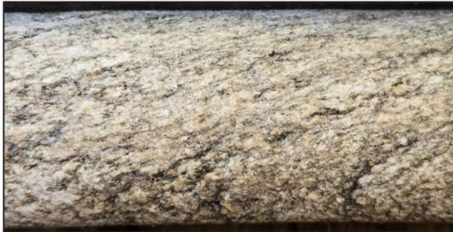
Aspecto de los gneises félsicos con foliación bien desarrollada a \approx 30^\circ respecto al eje de la perforación. Ancho del testigo = 63,50[mm]
