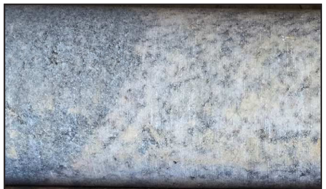
Contacto entre bandas máficas y félsicas (contenido en biotita) en testigo de Clase I/II de alteración meteórica. Altura de la foto: 63,50[mm].
