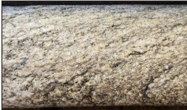
Aspecto de los gneises félsicos con foliación bien desarrollada a \approx 30^\circ respecto al eje de la perforación. Ancho del testigo = 63,50[mm]
