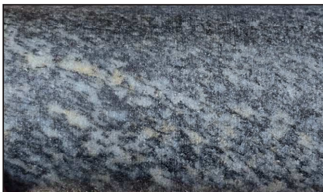
Foliación bien desarrollada en una zona del testigo en Clase I de alteración.
