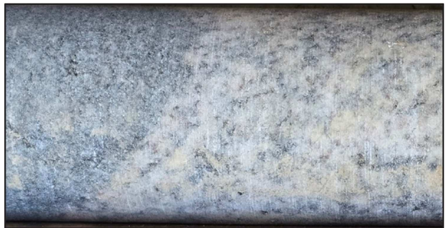
Contacto entre bandas máficas y félsicas (contenido en biotita) en testigo de Clase I/II de alteración meteórica. Altura de la foto: 63,50[mm]
