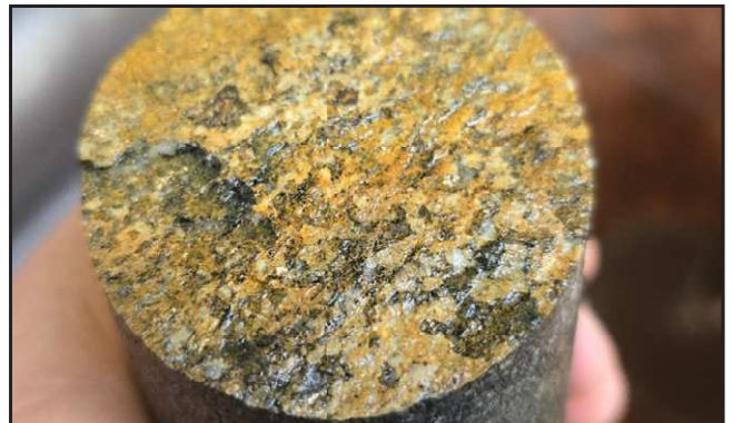
Detalle de plano de fractura con estrías y trituración de minerales. Se aprecian depósitos de oxihidróxidos de hierro.
