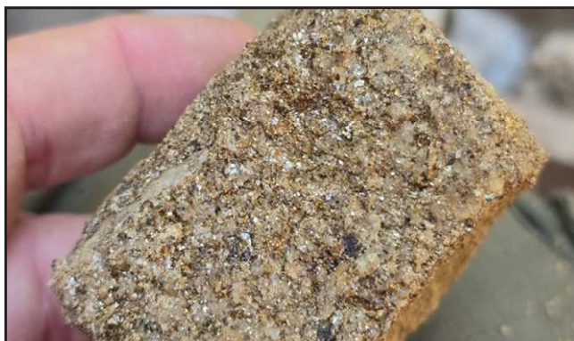
Gneis máfico (rico en biotita) en plano de fractura consecuente. Clase IV de alteración.
