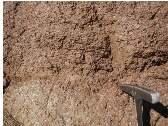
Grado IV: roca descompuesta, aparece arcilla matricial. La roca se puede partir con las manos y las ensucia con arcilla. El golpe del martillo es amortiguado (sin rebote).
