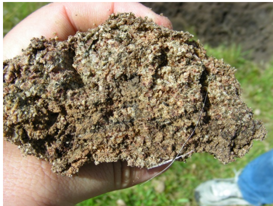
Grado V: roca completamente argilizada, pero conservando la textura original. Aparecen abundantes sustituciones de cristales por arcilla. La roca se parte con las manos y puede llegar a compactarse dentro del puño. En contacto con el agua se deslíe completamente.
