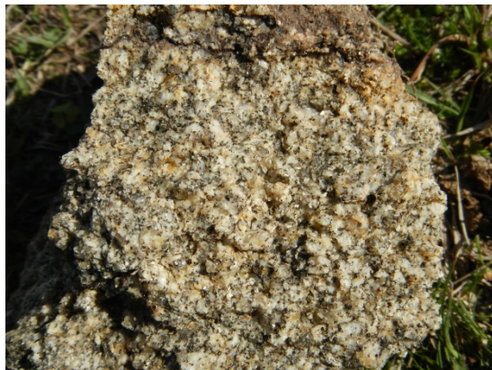
Grado III: cambios de colores pronunciados en la roca, medianamente friable (pueden extraerse cristales individuales de la matriz) pero no se rompe con la mano. Los minerales ferromagnesianos (biotita, hornblenda) muestran halos coloreados que tiñen al resto de la roca.
