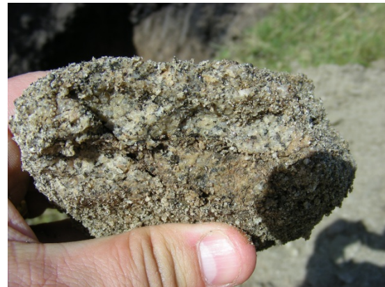
Grado V: roca completamente argilizada, pero conservando la textura original. Aparecen abundantes sustituciones de cristales por arcilla. La roca se parte con las manos y puede llegar a compactarse dentro del puño. En contacto con el agua se deslíe completamente.
