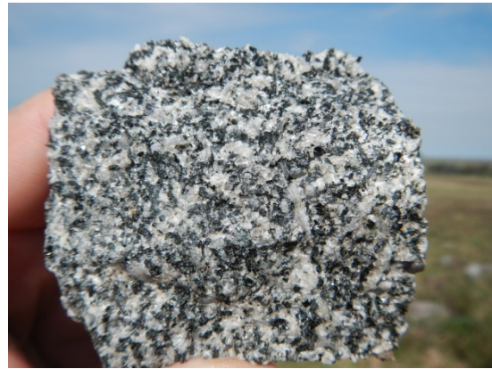
Grado I: roca fresca, inalterada. No se aprecian cambios de color o desagregación de la roca.
