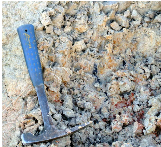
Asencio areno-arcilloso típico. Deleznable, muy arcilloso, con nódulos ferrificados muy dispersos. El color grisáceo es característico.
