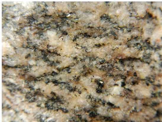
Grado II: roca con indicios de meteorización. Aparecen colores ocreos o naranjas. Los cristales de biotita muestran una decoloración al dorado – vermiculitización incipiente – pero se mantiene la coherencia o tenacidad incambiada. Se requieren varios golpes del martillo para la extracción de una muestra.
