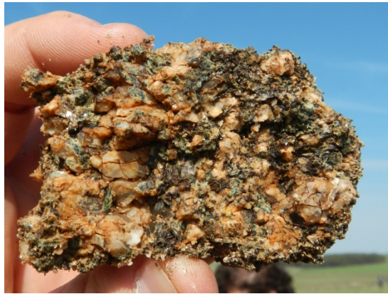
Grado IV: roca descompuesta, aparece arcilla matricial. La roca se puede partir con las manos y las ensucia con arcilla. El golpe del martillo es amortiguado (sin rebote).
