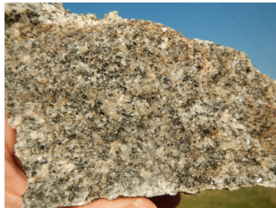
Grado II: roca con indicios de meteorización. Aparecen colores ocreos o naranjas. Los cristales de biotita muestran una decoloración al dorado – vermiculitización incipiente – pero se mantiene la coherencia o tenacidad incambiada. Se requieren varios golpes del martillo para la extracción de una muestra.
