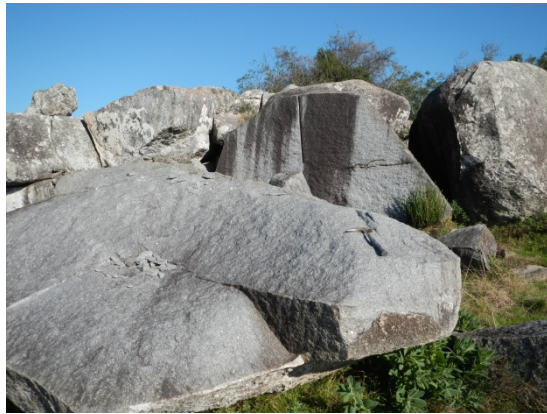
Grado I: roca fresca, inalterada. No se aprecian cambios de color o desagregación de la roca.
