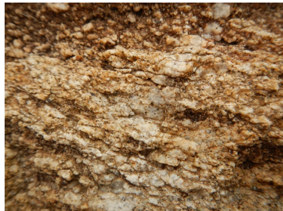
Grado III: cambios de colores pronunciados en la roca, medianamente friable (pueden extraerse cristales individuales de la matriz) pero no se rompe con la mano. Los minerales ferromagnesianos (biotita, hornblenda) muestran halos coloreados que tiñen al resto de la roca.
