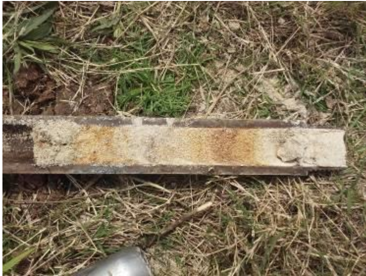
ILUSTRACIÓN 5– ARENA MEDIA A FINA ESTRATIFICADA EN MUESTREADOR DE SPT
