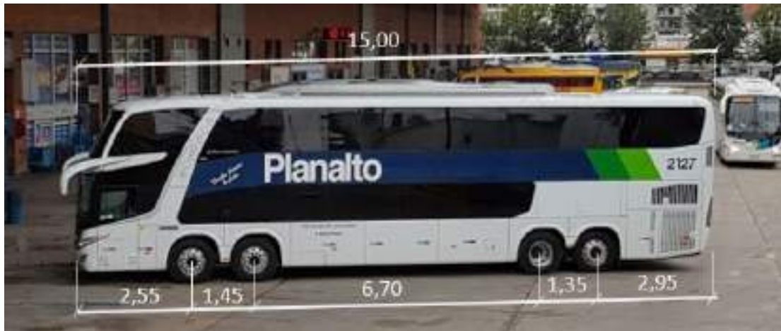
Figura 1 - Dimensiones del ómnibus. Medidas en metros.
