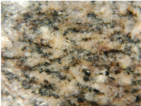
Grado II: roca con indicios de meteorización. Aparecen colores ocre o naranjas. Los cristales de biotita muestran una decoloración al dorado – vermiculitización incipiente – pero se mantiene la coherencia o tenacidad incambiada. Se requieren varios golpes del martillo para la extracción de una muestra.
