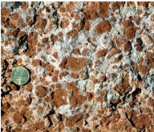
Zona moteada. La arenisca arcillosa desarrolla una textura particular donde la ferrificación aparece en formas poliédricas desconectadas.
