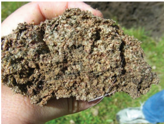
Grado V: roca completamente argilizada, pero conservando la textura original. Aparecen abundantes sustituciones de cristales por arcilla. La roca se parte con las manos y puede llegar a compactarse dentro del puño. En contacto con el agua se deslía completamente.
