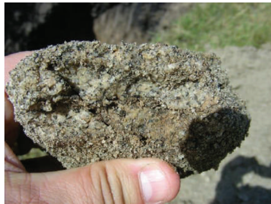
Grado V: roca completamente argilizada, pero conservando la textura original. Aparecen abundantes sustituciones de cristales por arcilla. La roca se parte con las manos y puede llegar a compactarse dentro del puño. En contacto con el agua se deslía completamente.
