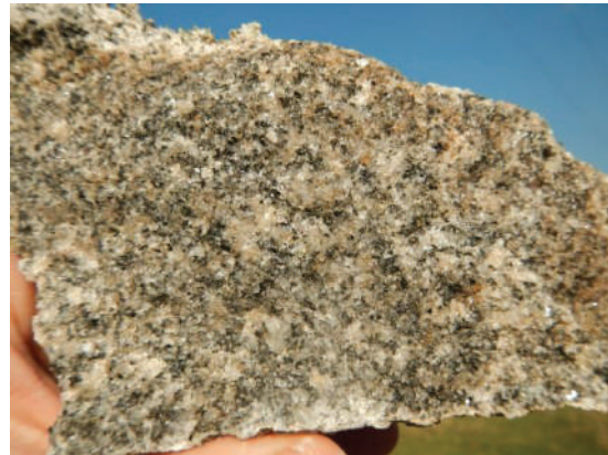
Grado II: roca con indicios de meteorización. Aparecen colores ocre o naranjas. Los cristales de biotita muestran una decoloración al dorado – vermiculitización incipiente – pero se mantiene la coherencia o tenacidad incambiada. Se requieren varios golpes del martillo para la extracción de una muestra.
