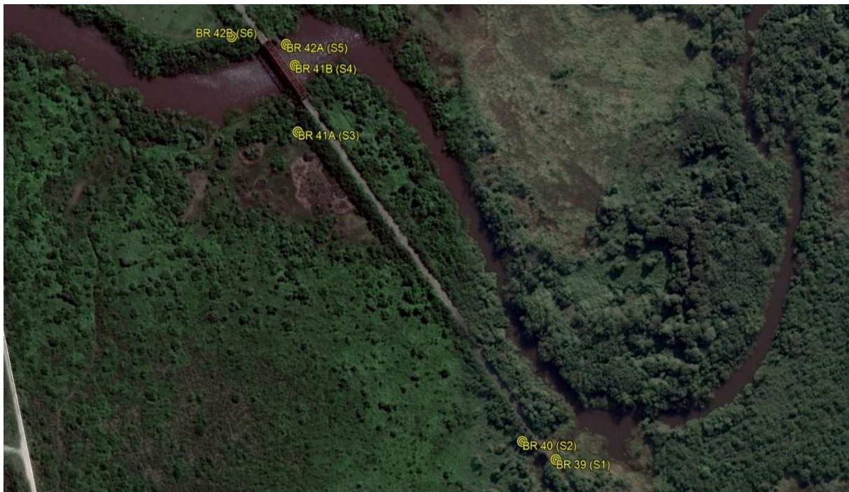
Ubicación de sondeos realizados en puente FFCC sobre Rio Canelón Grande, Canelones.
