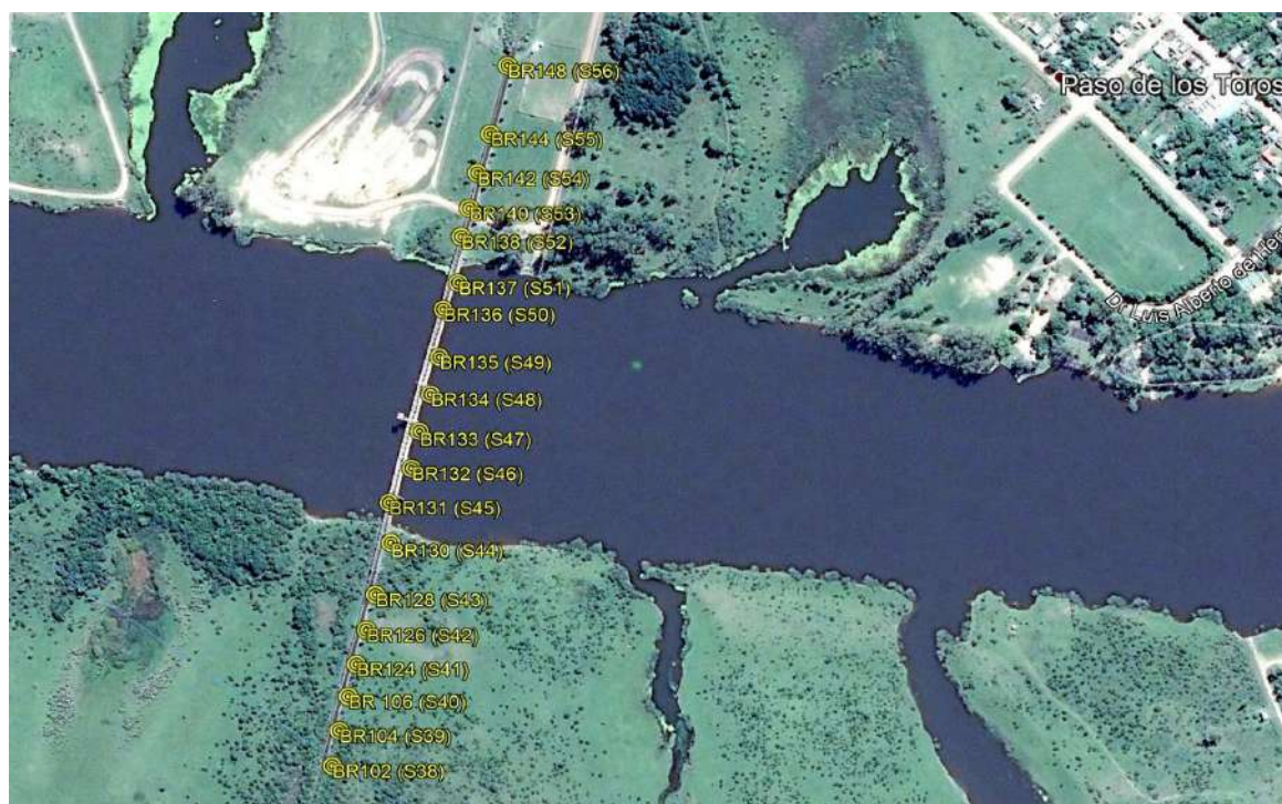
Ubicación de sondeos realizados en puente FFCC sobre Rio Negro, Paso de los Toros.
